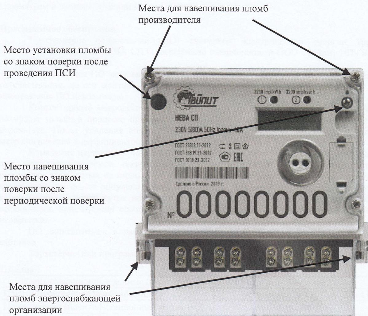
Рисунок 1 - Внешний вид счетчика НЕВА СП3 с указанием мест пломбирования
