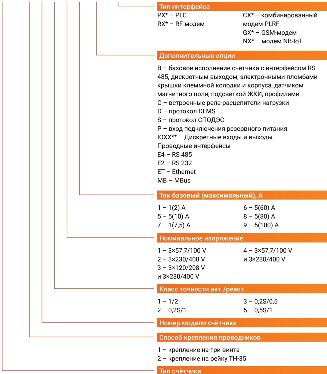
\* X – исполнение модема, буква E после цифры исполнения, обозначает возможность установки выносной антенны;
