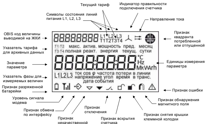
Рисунок 2.3 – Расположение информации на индикаторе
