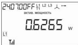
Рисунок 2.10 – Меню 10 кадр 2. Мощность активная по фазе А, в Вт
