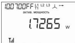
Рисунок 2.9 – Меню 10 кадр 1. Мощность активная всего, в Вт
