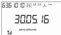
Рисунок 2.14 – Меню 11 кадр 4. Начальный кадр подгруппы. Дата последнего отключения питания в формате ДДММГГ
