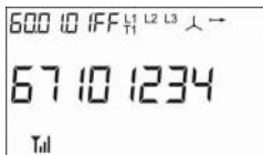
Рисунок 2.16 – Меню 12 кадр 1. Адрес счетчика
