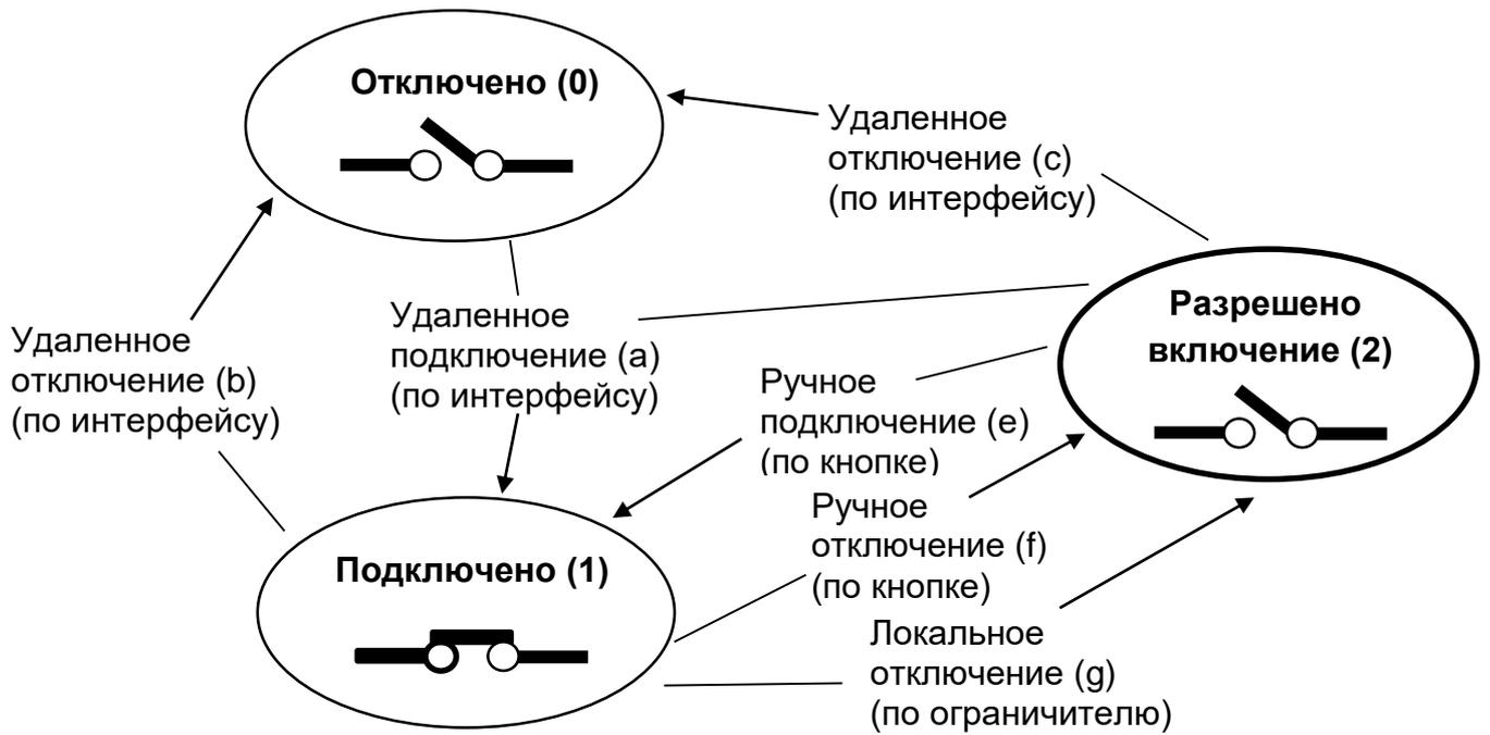
Рисунок 1.4 – Режим работы 2. Разрешены переходы a, b, c, e, f, g.
