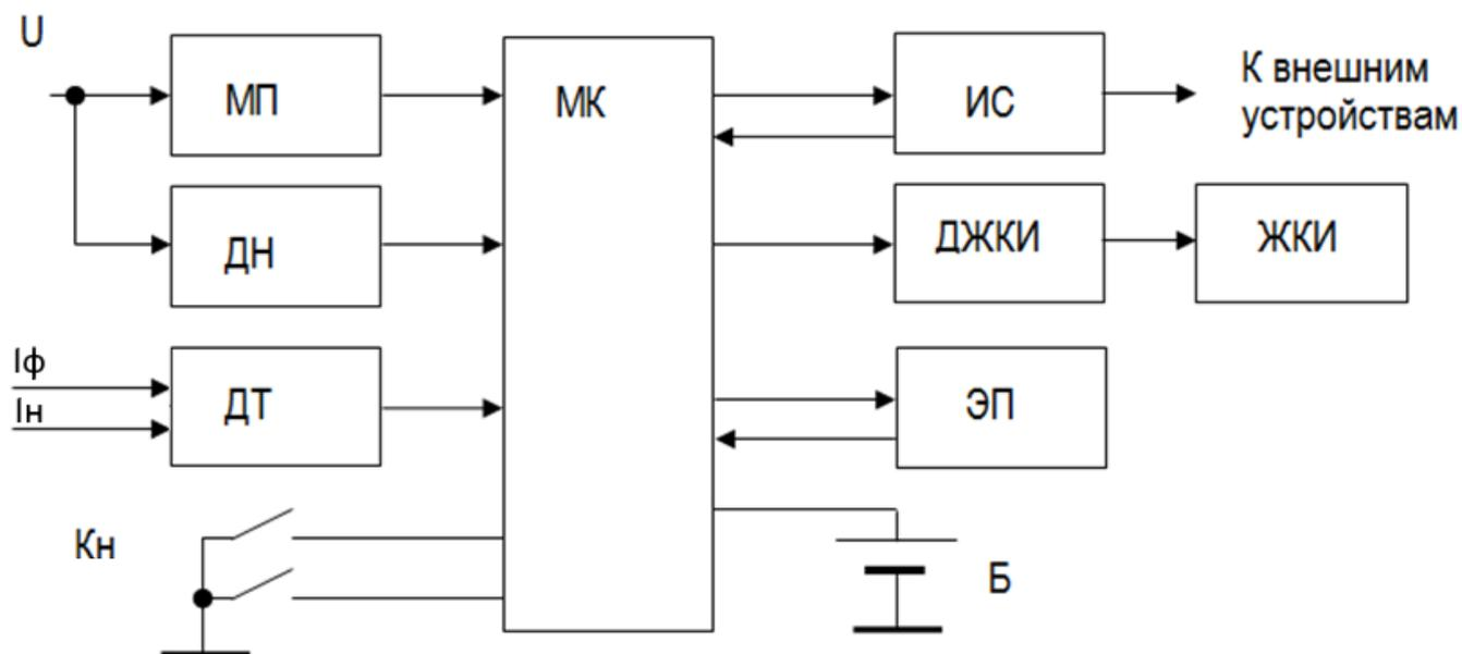
Рисунок 1.2 – Функциональная схема счетчика
