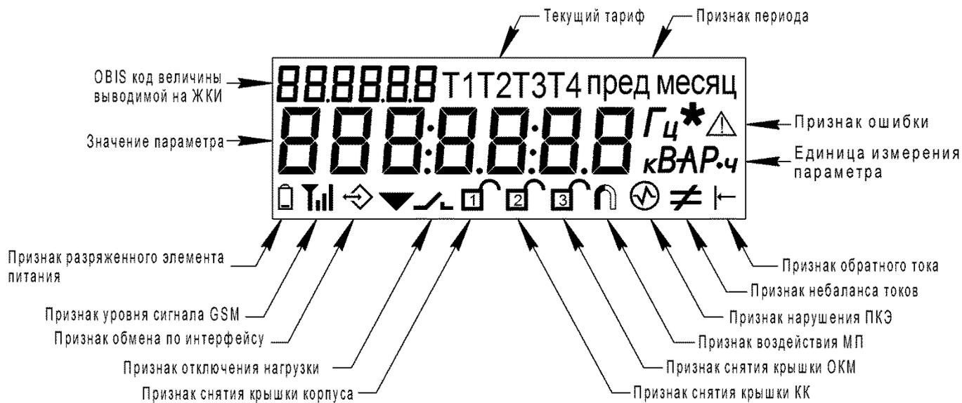
Рисунок 2.2 – Расположение информации на индикаторе
