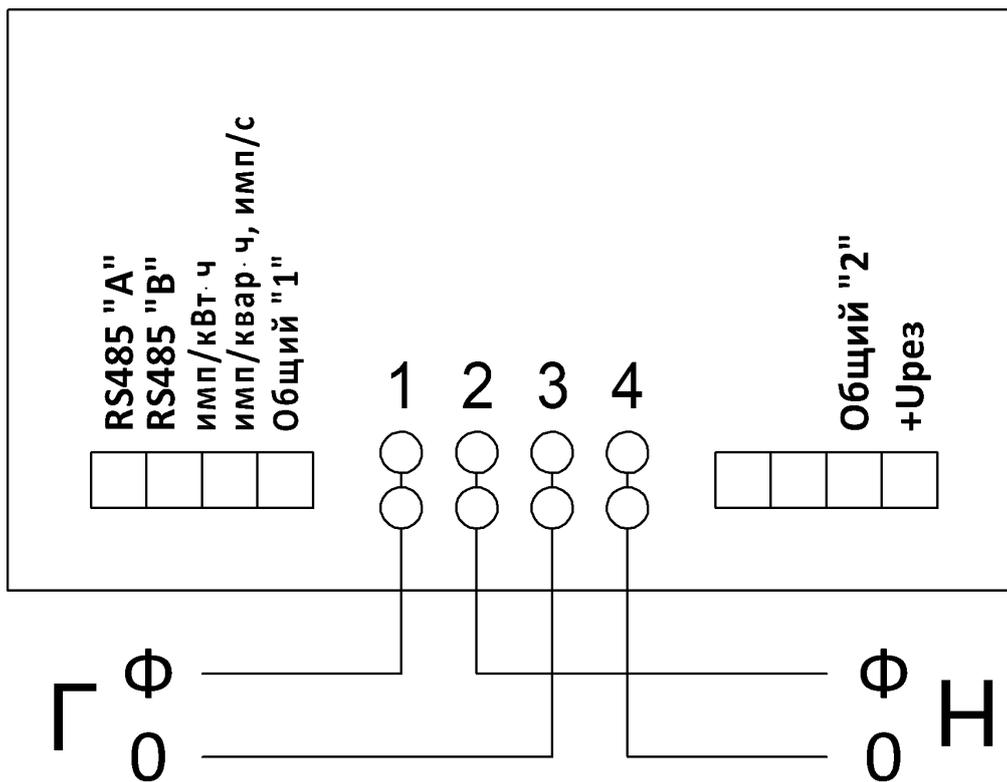
Схема подключения счетчика НЕВА СТ21Х
