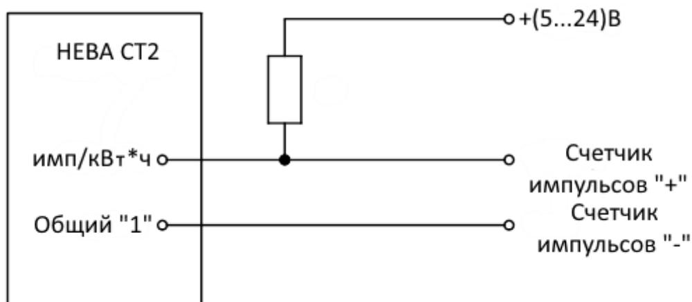
Схема подключения импульсного выхода счетчика HEBA CT2
