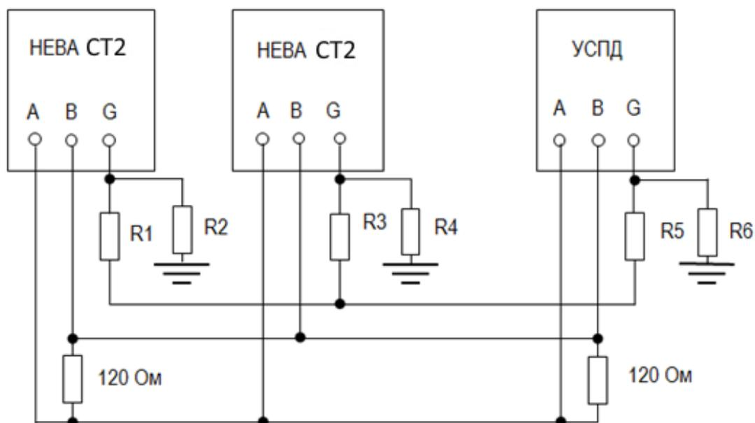
Рисунок 2.1 – Схема подключения счетчиков к интерфейсной линии EIA-485
