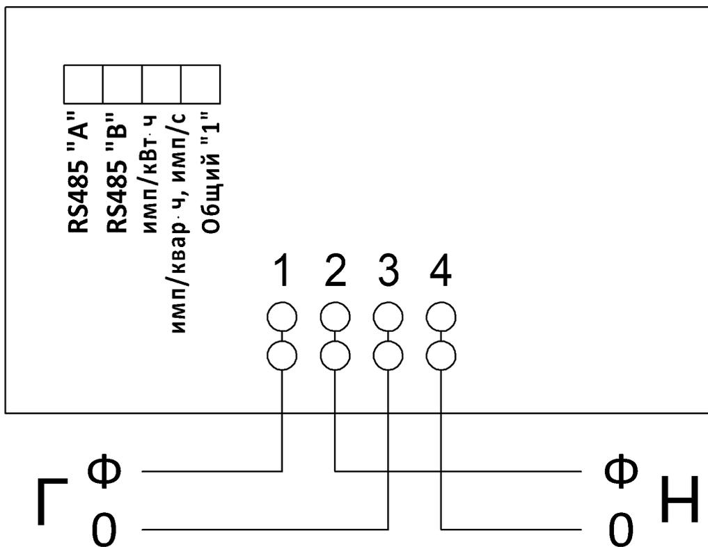
Схема подключения счетчика НЕВА СТ22Х
