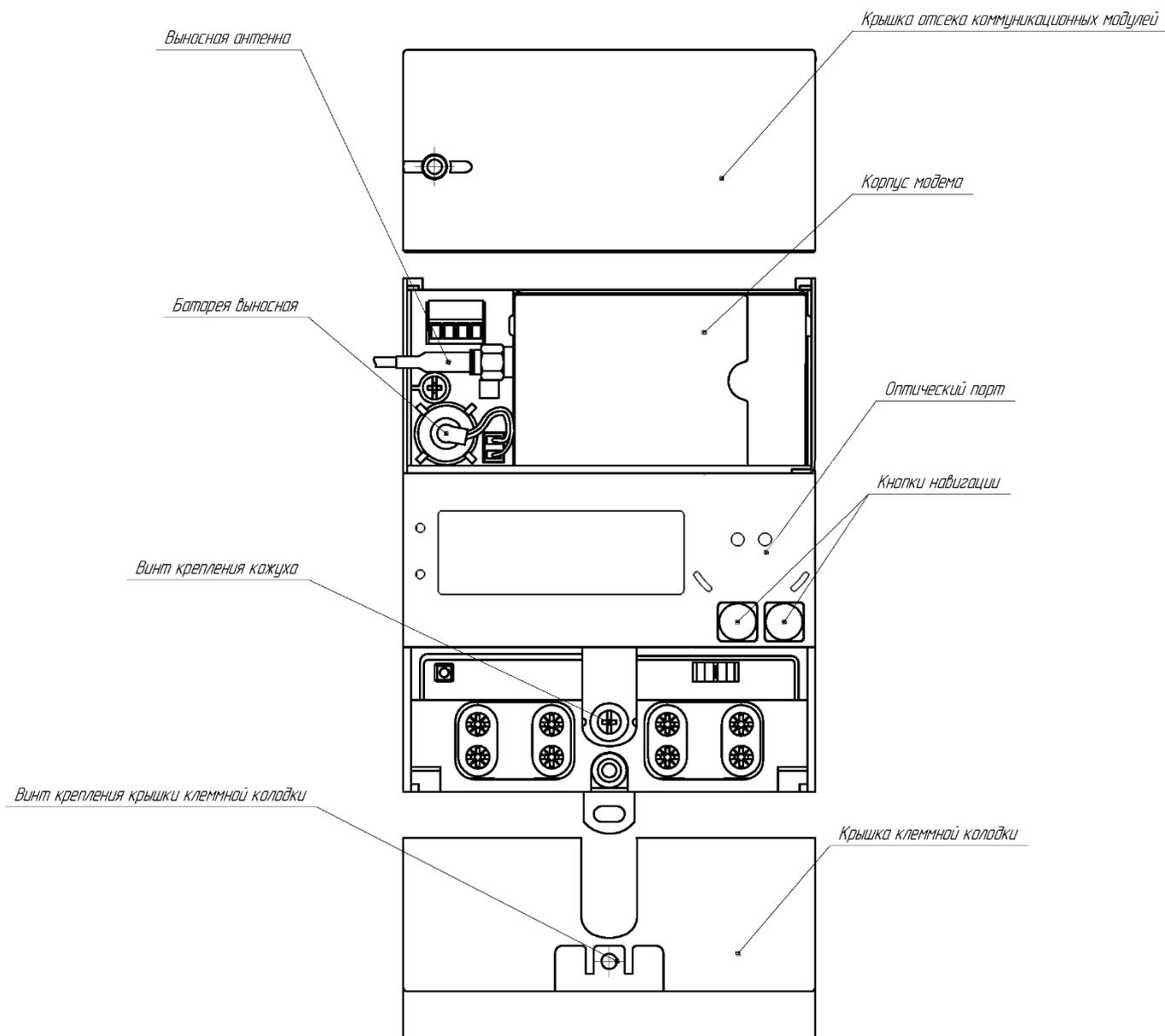
Внешний вид счетчика НЕВА СТ22Х с удлиненной крышкой клеммной колодки и со снятыми крышкой клеммной колодки и крышкой отсека коммуникационных модулей
